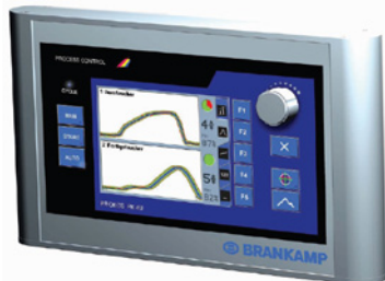
Slika 2: Primer izmerjene analogne krivulje tehnološkega procesa in nadzorni procesni sistem Brankamp (Brankamp, 2011)
